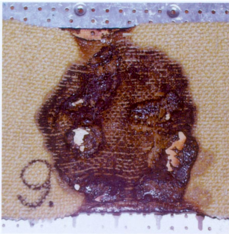
Bild 26d Teppich ist 7 mm dick, Polhöhe 4 mm, 50 ml Spiritus breiten sich auf Ø 12 cm aus. Spiritusbenetzte Fläche ca. 113 cm 2
