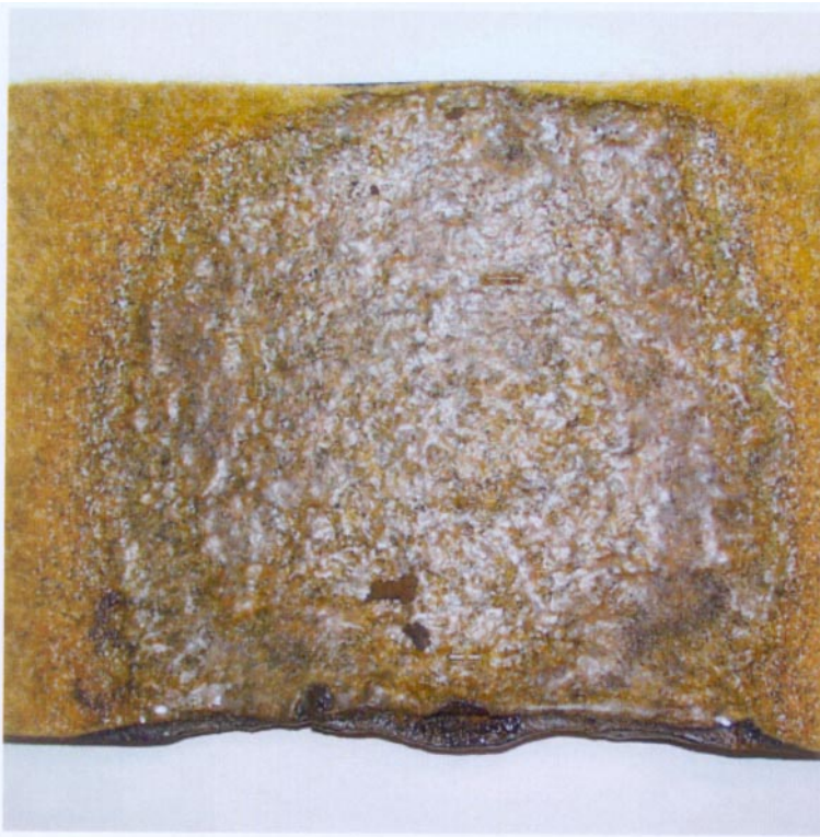
Bild 22d Teppich ist 9 mm dick, Polhöhe 7 mm, 50 ml Spiritus breiten sich auf Ø 12 cm aus. Spiritusbenetzte Fläche ca. 113 cm 2
