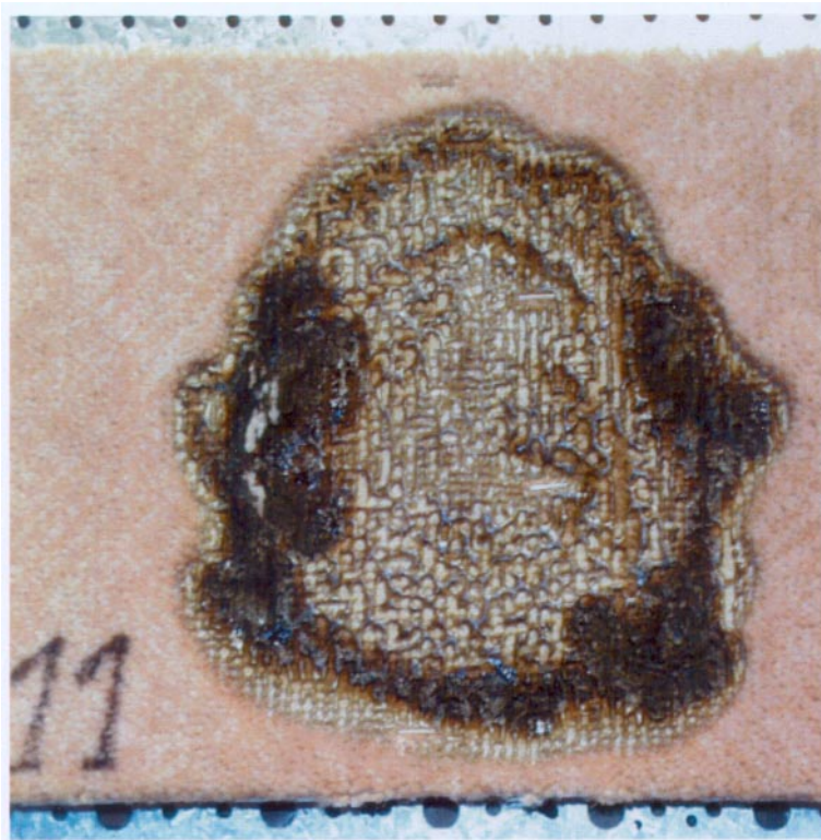
Bild 28d Teppich ist 8 mm dick, Polhöhe 6 mm, 50 ml Spiritus breiten sich auf Ø 10,5 cm aus. Spiritusbenetzte Fläche ca. 87 cm 2
