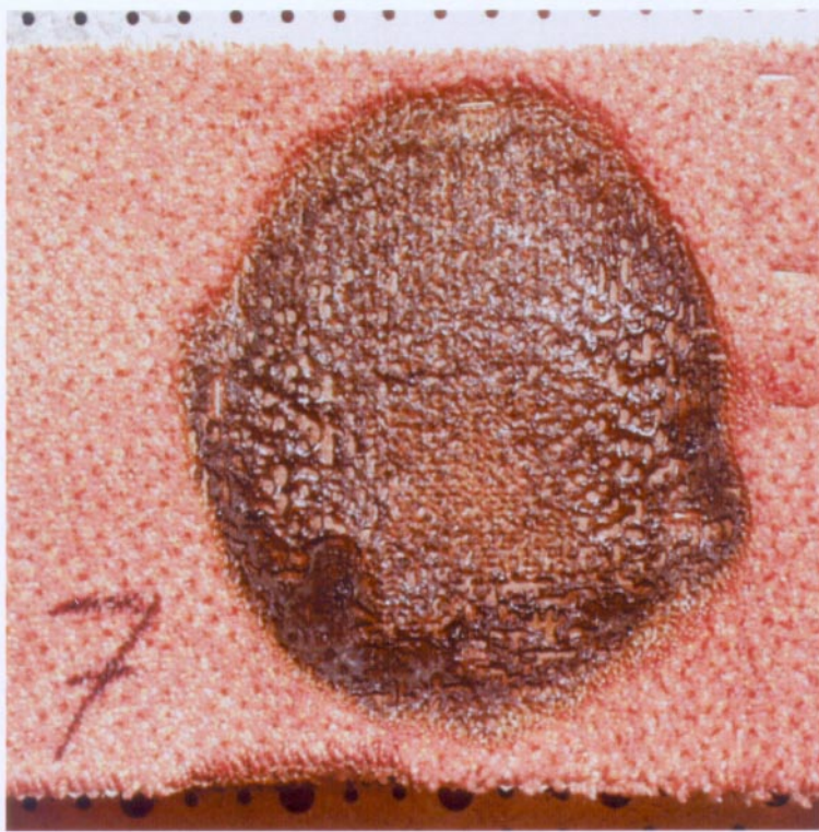
Bild 24d Teppich ist 7 mm dick, Polhöhe 5 mm, 50 ml Spiritus breiten sich auf Ø 12 cm aus. Spiritusbenetzte Fläche ca. 113 cm 2
