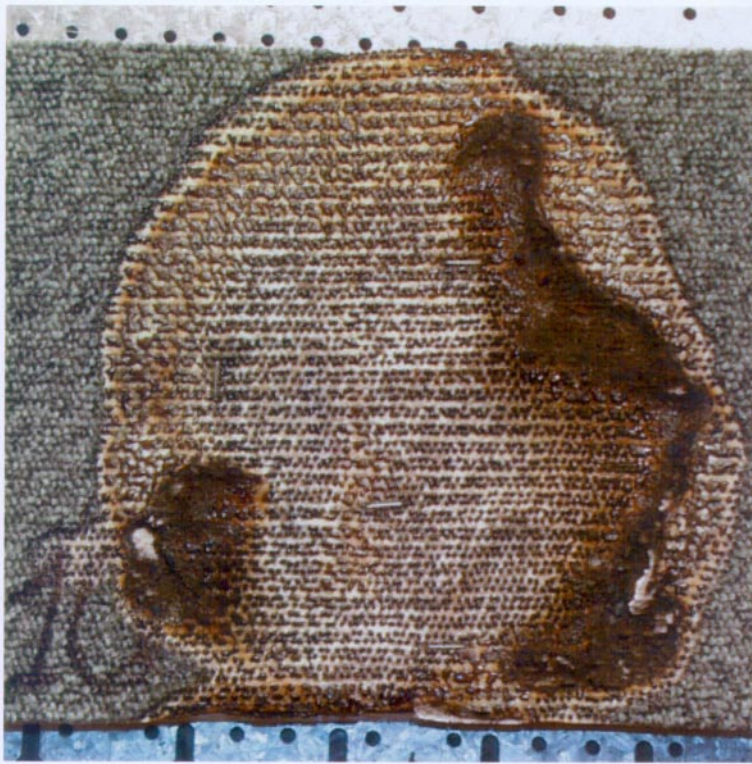
Bild 27d Teppich ist 4 mm dick, Polhöhe 2 mm, 50 ml Spiritus breiten sich auf Ø 17 cm aus. Spiritusbenetzte Fläche ca. 227 cm 2
